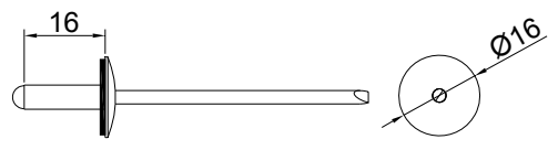
Sur ossature Aluminium Rivet Alu/Inox à tête laquée Ø16 - Ø4,8 x 16 avec rondelle d'étanchéité EPDM.
